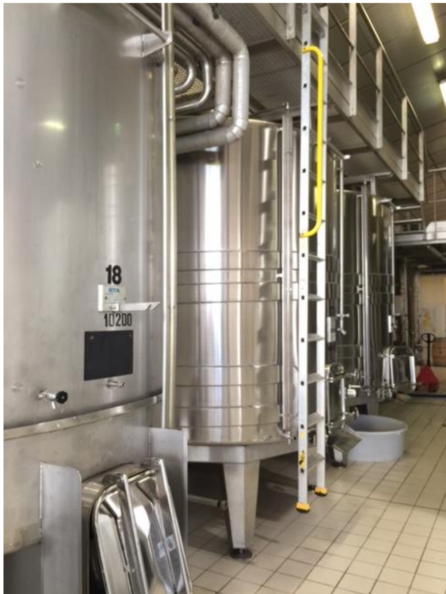
① 「醗酵」のためのタンク
